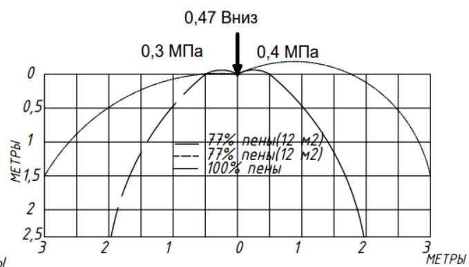
**Графики зависимости интенсивности от давления для оросителей водяных и пенных для высоты 2,5 м
